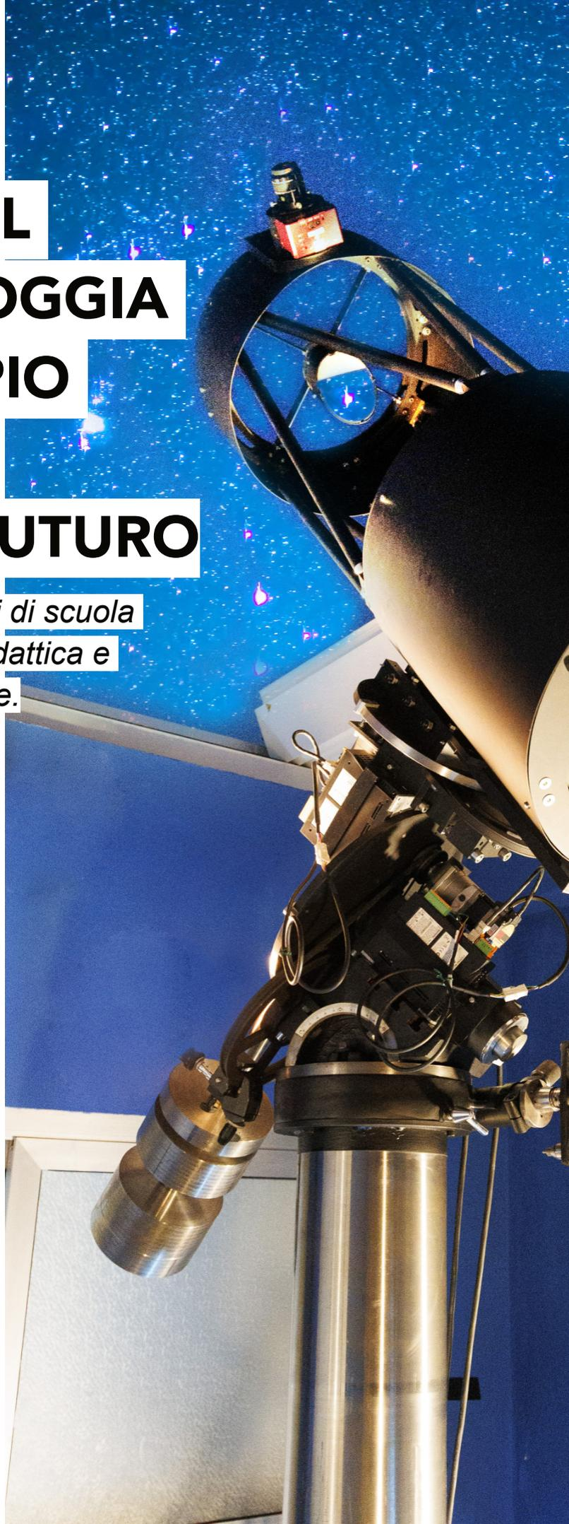
***Tra maggio e giugno 2024 sono stati montati il telescopio principale e completata la struttura dell'osservatorio, dotata di tetto scorrevole per consentire l'osservazione del cielo in condizioni ottimali.***
